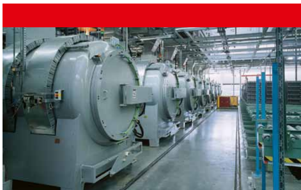
Automatisierte Nitrier-/ Nitrocarburierlinie bei Automobilhersteller
