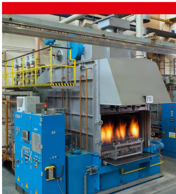
Ausschnitt aus automatischer Mehrzweckkammerofen-Linie Typ MKE 4-1 Hersteller von Profilrollwerkzeugen
