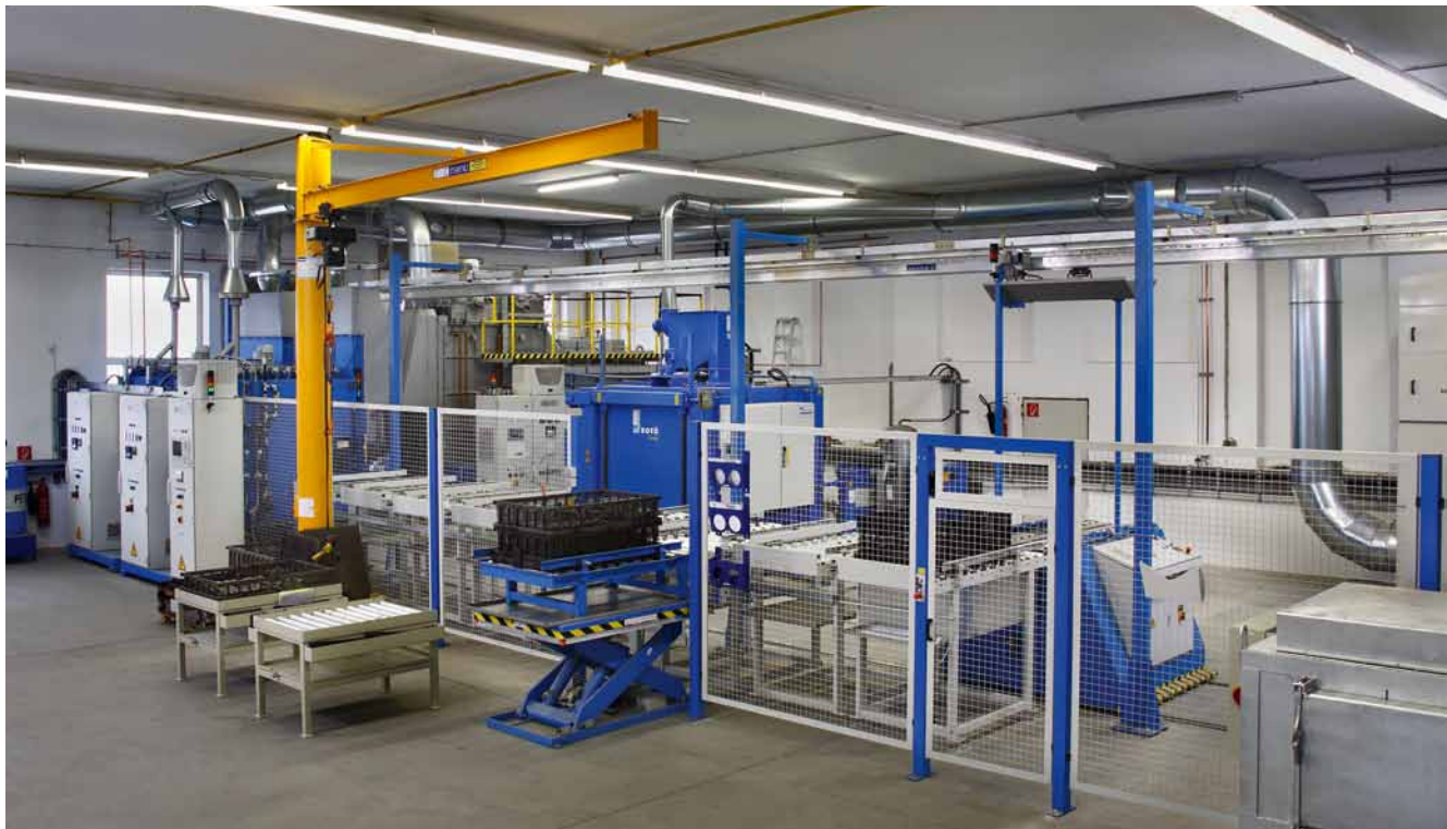
Automatisierte Mehrzweckkammerofen- Anlage bei Lohnhärte- betrieb, Wels, Österreich
