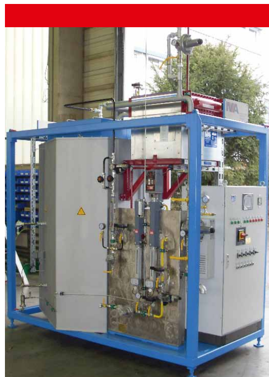
Endogas Schutzgaserzeuger Typ Endo 30, elektrisch beheizt, luftgekühlt, mit automatischer Mengen- und Analysenregelung
