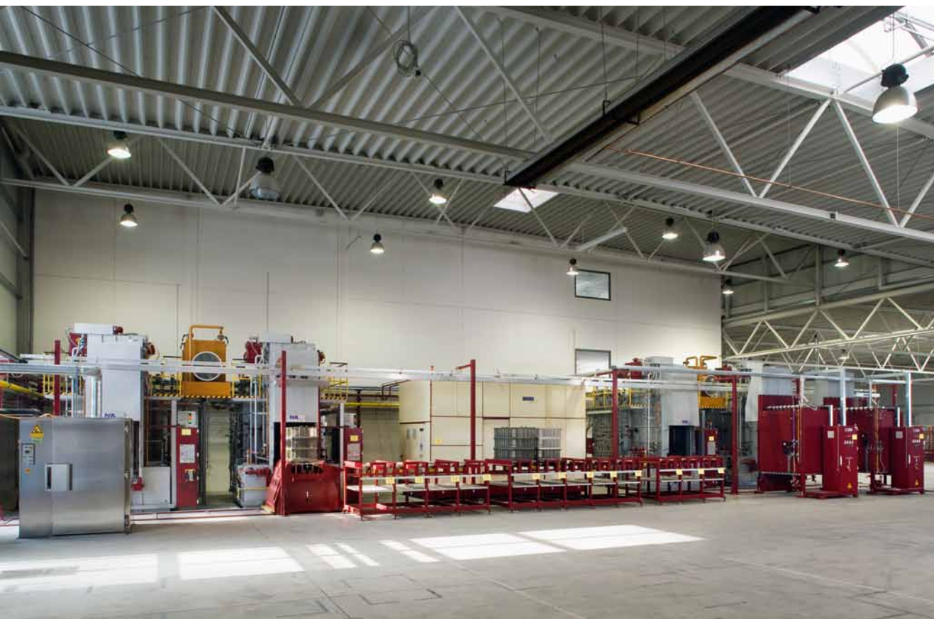
Automatisierte Mehrzweck-Kammerofenlinie bei Lohnhärterbetrieb, Deutschland
