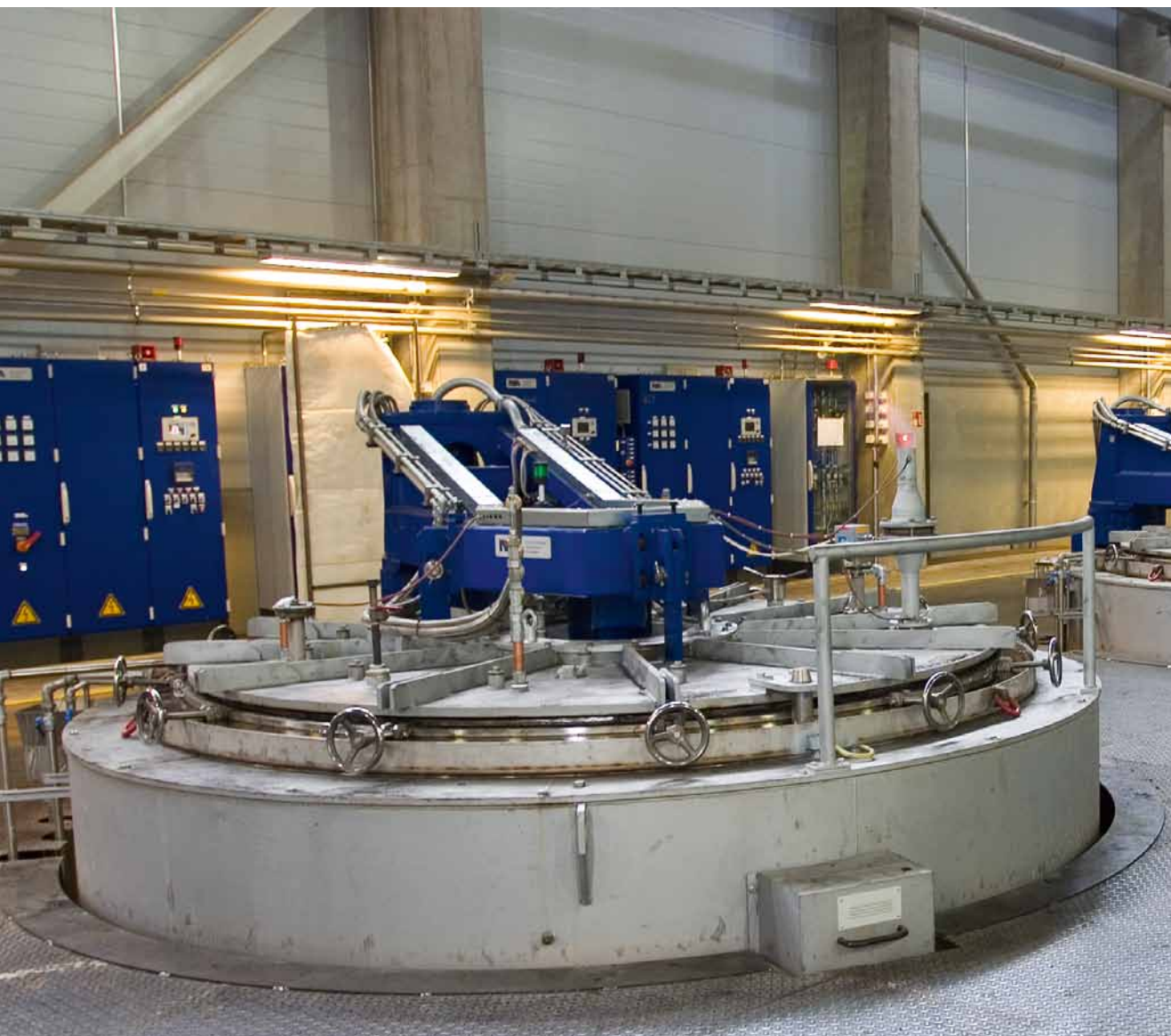
Schacht-Retortenofen Typ VR 25/23 zum Gasaufkochen von Getriebeteilen für Wind- kraftanlagen
